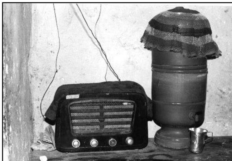
**Figura 2.18:** Rádio alimentado através de fiação improvisada.
